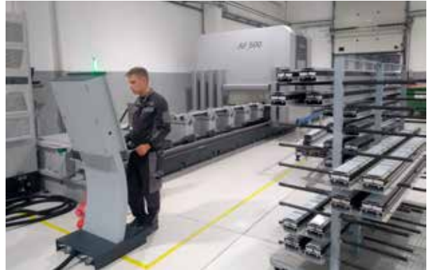
Moderner Maschinenpark: Mit der Schüco CNC-Bearbeitungsmaschine AF 500 lassen sich die Betriebsabläufe forciert vernetzen.
